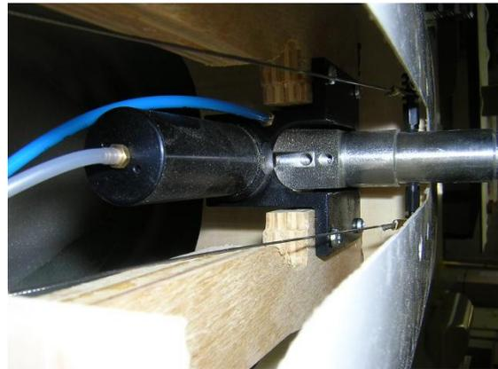
Si nécessaire, ajouter deux ressorts très doux ou des élastiques pour tendre les câbles de direction lors de la rétraction du train.
