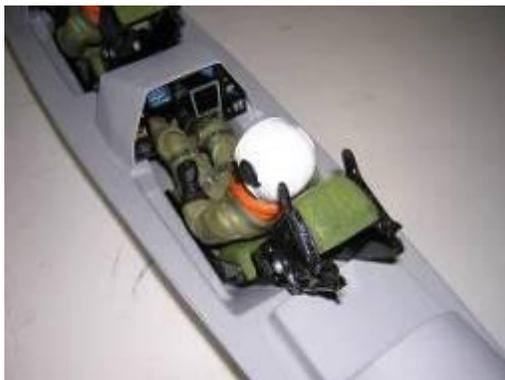
Le baquet et ses pilotes peuvent être laissés libre et mis en position avant fermeture de la verrière.
