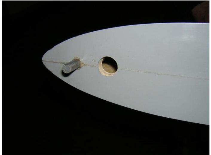
Percer un trou de 5 mm dans l'emplanture du fuselage pour le passage du fil de servo.
