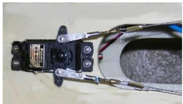
Si nécessaire, ajouter deux ressorts très doux ou des élastiques pour tendre les câbles de direction lors de la rétraction du train.
