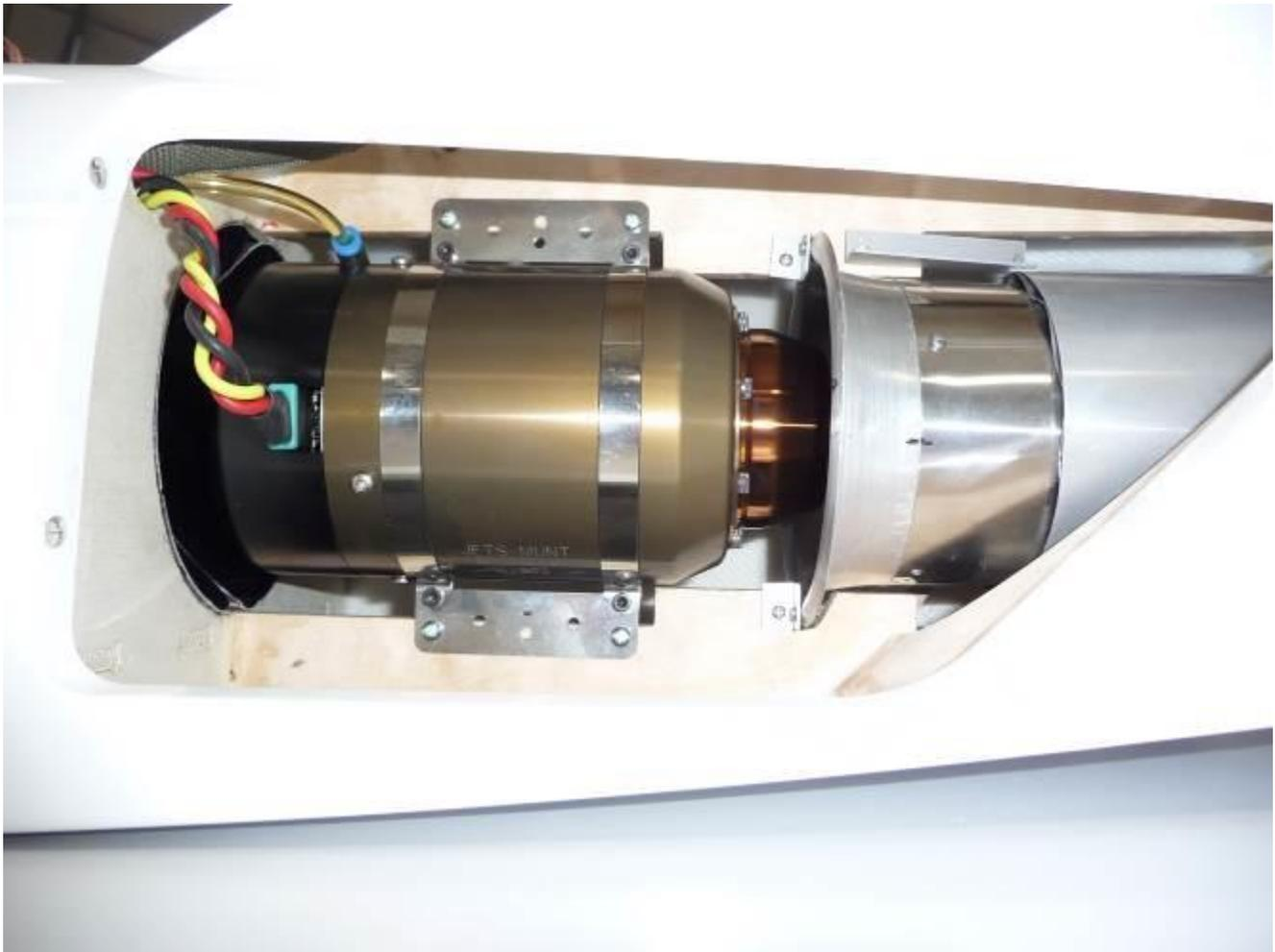
Attacher si nécessaire tous les câbles électriques et tuyaux carburant à l'aide de T rap au fuselage afin d'éviter toute aspiration de ceux-ci par le réacteur.
