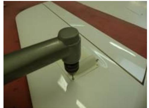
Percer 4 trous de 1 mm dans le stab pour les 4 vis
