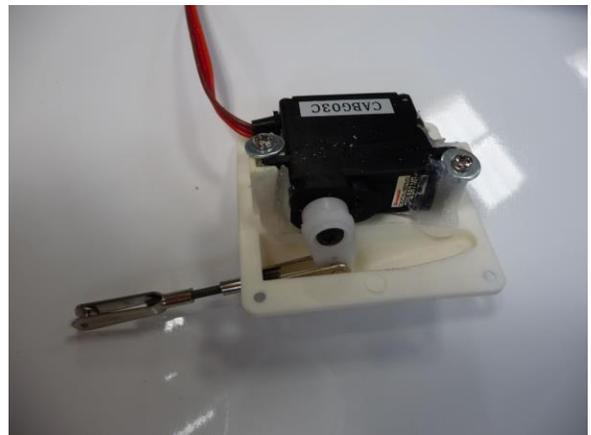
Mettre en place le support servo sur la dérive.
