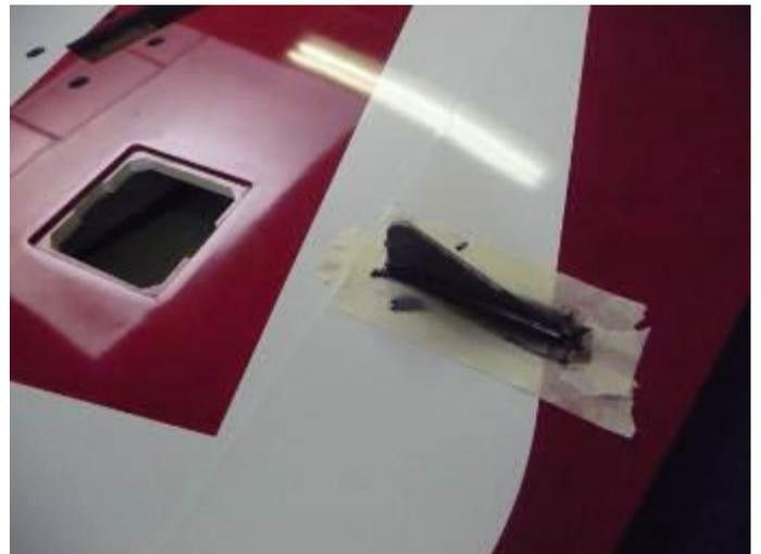
Pratiquer un large trou dans l'emplanture de l'aile pour le passage des fils de servos et des tuyaux d'air du train rentrant.
